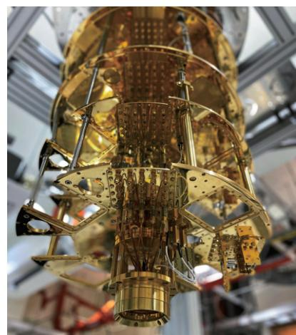
量子電腦及相關量子元件研究所使用之極低溫系統
